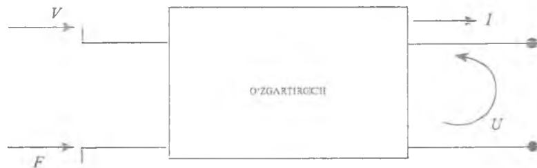
4.1-rasm. Elektromexanik o'zgartirgichning umumiy sxemasi,
