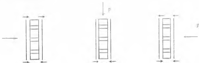
5.18 — расм. Кардиоидали йўналганлик диаграммаси шаклланишига оид.
