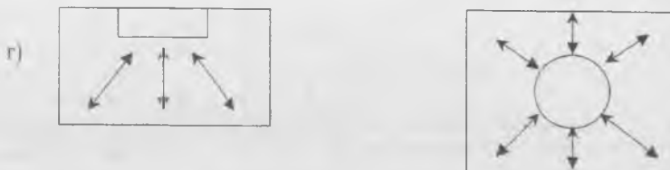
8.1—расм. Бир жойга тўпланган тизимлар ва уларни жойлаштириш вариантлари а) пештоқ марказида; б, в) пештоқ ён деворларида; г) зал марказида.
