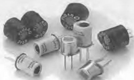
1.81-расм. Замон авий газ тарқибини аниқловчи датчиклар қўриниши ва уланиш схемаси.
