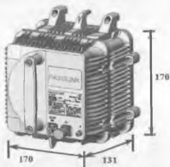
9.9-rasm. 6-7-8GGts diapazonlardagi orttirilgan quvvatli ODU ning tashqi ko'rinishi
