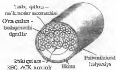
3.23-rasm. Tipik SCSI kabeli konstruksiyasi.
