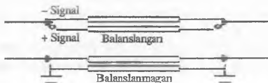
3.20-rasm. Balanslangan (differensial) va balanslanmagan (bir liniyali) shinalar.
