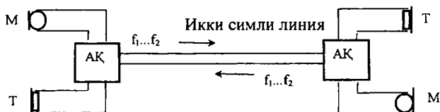
1.19-расм. Икки томонлама боғланишни ташкил қилишнинг бир полосали икки симли схемаси.
