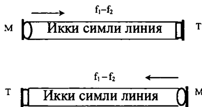
1.18-расм. Икки томонлама телефон алоқани ташкил қилишнинг бир полосали тўрт симли схемаси.
