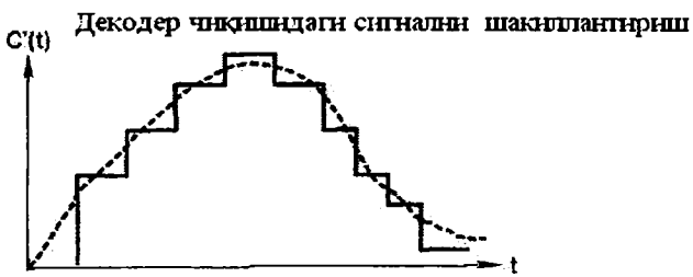
3.18-расм. ДИКМ сигнал шаклланишининг вақт бўйича диаграммалари.
