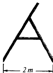
20-rasm. Uzunlik o'lchov asboblardan ruletka va dala sirkuli.
