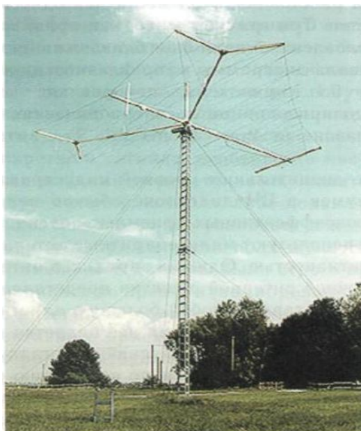
11.1-расм. Горизонтал кутбланган ўрнатилган жойига нисбатан холатини ўзгартириш имконияти бор логопериодик антенна
