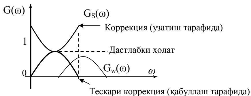
11.3-расм. Сигналга тўғри ва тескари коррекция киритиш.
