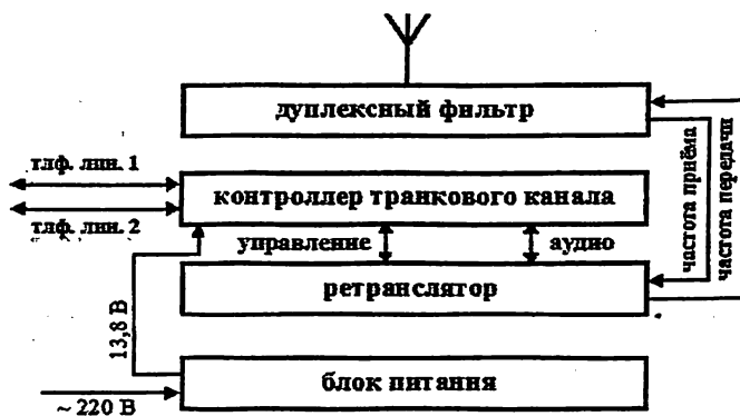
Рис.П.1.3. Структурная схема одноканальной транкинговой системы
