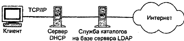
Рис.6. Процесс взаимодействия DHCP и LDAP
