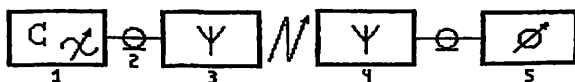
Рис.4.1. Структурная схема установки для исследования направленных свойств фазированной панельной антенны (1 – генератор, 2 – коаксиальный фидер, 3 – передающая антенна, 4 – приемная фазированная панельная антенна, 5 – резонансный волномер с индикаторным прибором)
