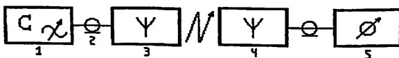
Рис.3.1. Структурная схема установки для исследования направленных свойств синфазной панельной антенны (1 – генератор, 2 – коаксиальный фидер, 3 – передающая антенна, 4 – приемная синфазная панельная антенна, 5 – резонансный волномер с индикаторным прибором)
