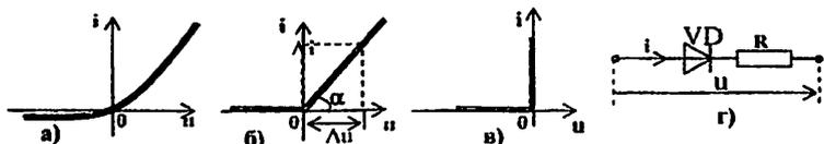
Рис. 13.1. ВАХ полупроводникового диода (а), его кусочно-линейная аппроксимация ВАХ (б), ВАХ идеального вентиля (в), схема замещения полупроводникового диода (г)
