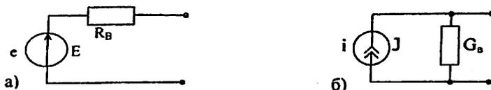
Рис.2.4. Последовательная (а) и параллельная (б) схемы замещения реальных источников
