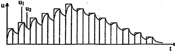
Рис. 9.3. Процесс выделения огибающей амплитудно-модулированных прямоугольных импульсов с помощью ИЦ (рис. 9.1,а)
