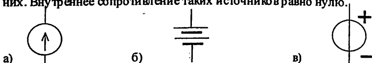
Рис. 2.1. Обозначение независимых источников напряжения. Стандарт: а) Россия; б) США; в) Германия
