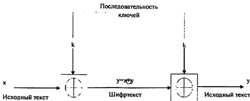
Рис. 3.1- Схема шифрования Вернама
