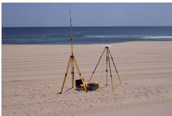
1.7-расм. GPS услубида жойда нуқтанинг планли координаталарини аниқлаш усули; GPS асбоблари
