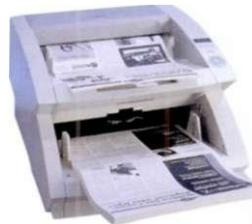
Китоб шаклида бўлмаган ҳужжатларни сканерлаш учун ишлатилади. Замонавий моделлар ҳужжатларни 1 дақиқада 320 бетгача бўлган тезликда сканерлайди.
