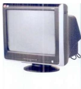
Катод нурли трубканинг иш тамойили экраннинг орка кисмида электрон нурининг олдинга ва оркага харакатланишига асосланган. Нурнинг экран оркали хар бир силжишида бу нур шиша трубканинг ички томонидаги фосфорли нукталарни, экраннинг фаол майдончаларини ёритади. Шундай чизикдар тупламани чизиш эвазига нур экранда тасвирнинг умумий суратини яратади.
