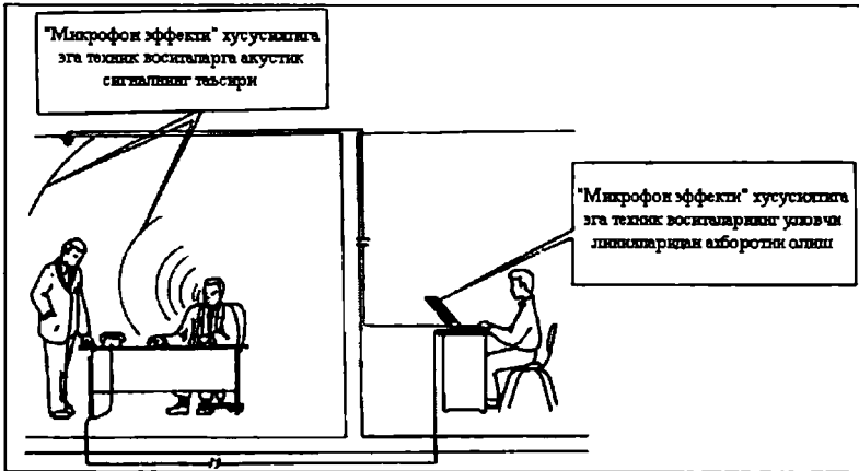
5.1-расм. "Микрофон эффекти" хусусиятига эга техник воситаларнинг акустик (нуткий) сигналларини тутиб олиши
