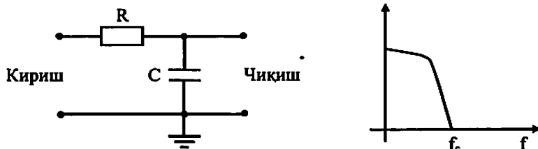
6.18-rasm. Past chastota filtrining sxemasi (chapda) va ishlashini grafik aks ettirilishi (o'ngda)
