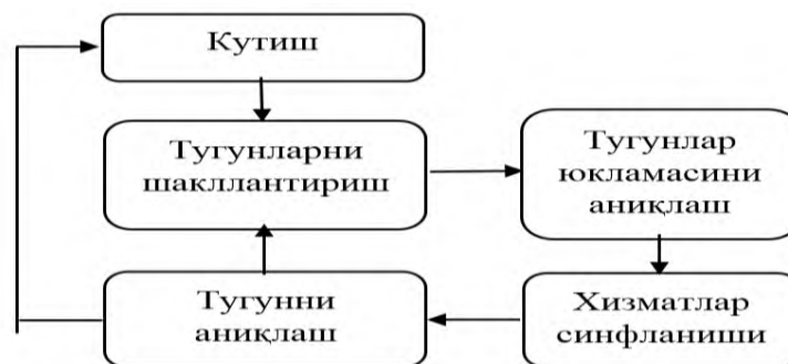
2.10-yuklamani balanslovchi agentning ishlash algoritmi.
