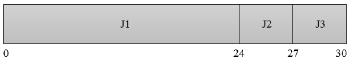
2.18- rasm. FCFS algoritmi bo‘yicha rejalashtirish sxemasi (1- misol)
