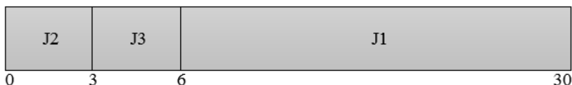
2.19- rasm. FCFS algoritmi bo‘yicha rejalashtirish sxemasi (2- misol)
