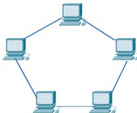
6.3- rasm. Xalqa topologiyasi asosida qurilgan tarmoq
