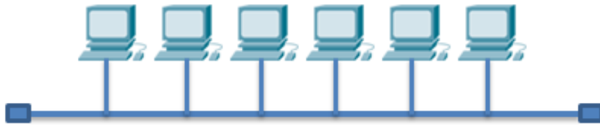
6.1- rasm. Shina topologiyasi asosida qurilgan tarmoq
