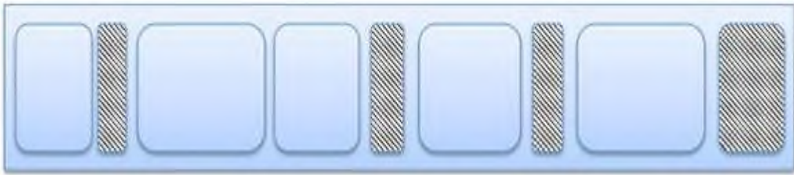
3.11- rasm. Siqishdan oldingi xotiradagi bo‘linish
