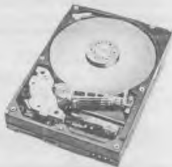
23 -расм. Қаттиқ дискга йиғувчи қурилма ҳимоя қобиғисиз
