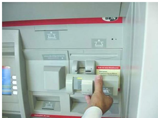
9- rasm. Bankomatning soxta birikmasi
