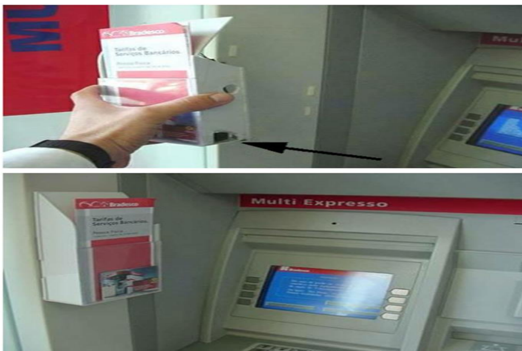
10- rasm. Reklama ostiga yashiringan va mijozning pin-kodini suratga oluvchi videokamera
