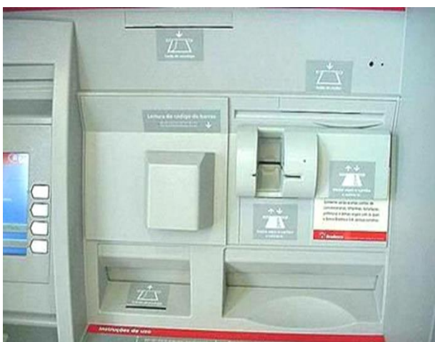
9- rasm. Bankomatning soxta birikmasi
