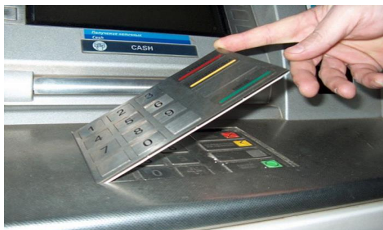
11- rasm. Kiritilayotgan pin-kodni qabul qiluvchi klaviatura qo‘shimchasi
