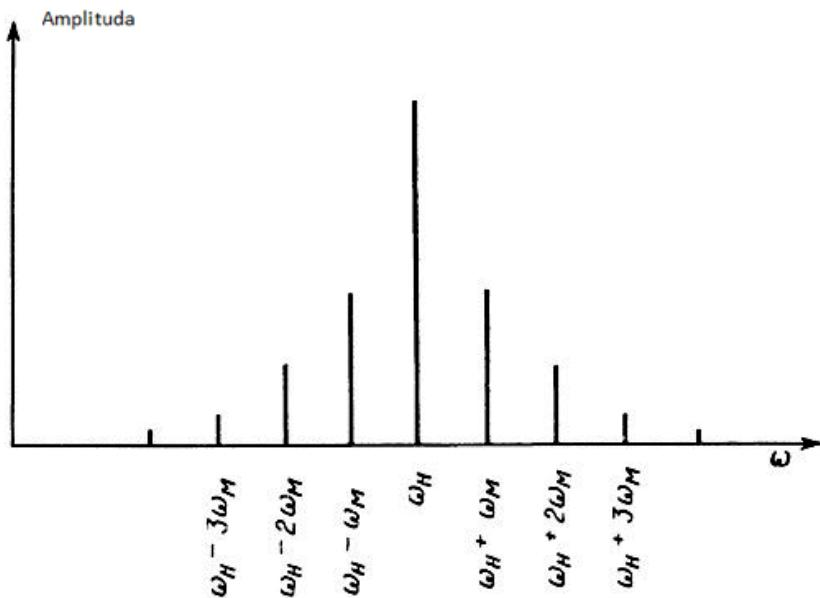
3.6-rasm. Chastota bo‘yicha modulyatsiyalangan signal spektori  $\omega_H$ -tashuvchi chastota ;  $\omega_M$ - modulyatsiyalash chastotasi.
