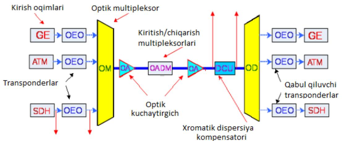
5.7-rasm. DWDM texnologiyasining ishlash tamoilini tushuntiruvchi sxemasi
