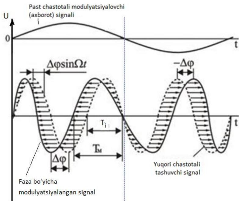
3.6 – rasm. Tashuvchini faza bo'yicha modulyatsiyalash jarayoni
