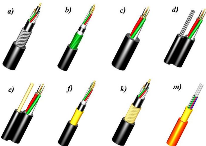
2.11-rasm. Optik tolali aloqa kabellari konstruksiyalari.
