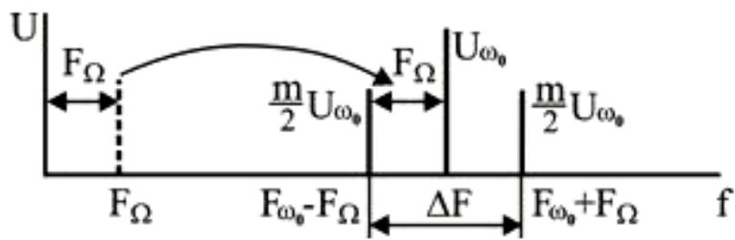
3.3-rasm. Amplituda bo‘yicha modulyatsiyalangan signalning spektori
