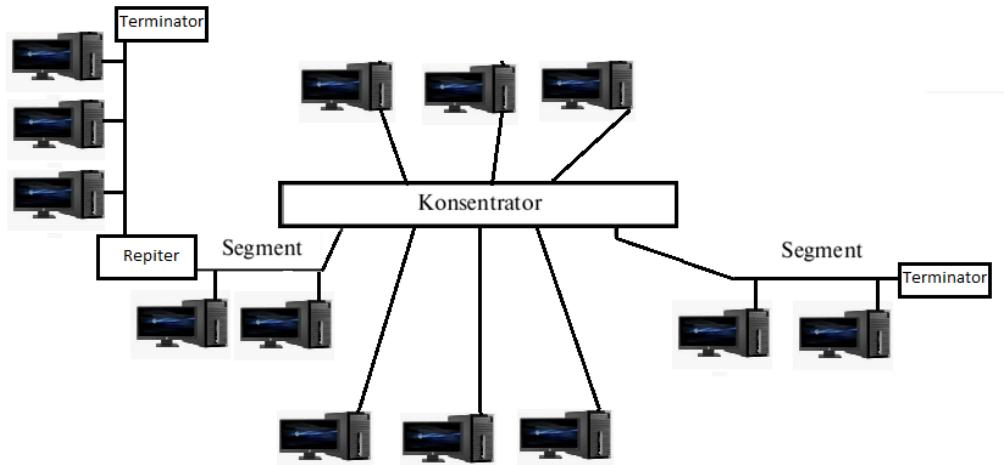
6.1 – rasm. Ethernet tarmog’i va unda tarmoq elementlarining
