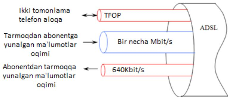
4.2 - rasm. ADSL texnologiyasi qo'llanilgan abonent liniyasida kanalarning xosil qilinishi.
