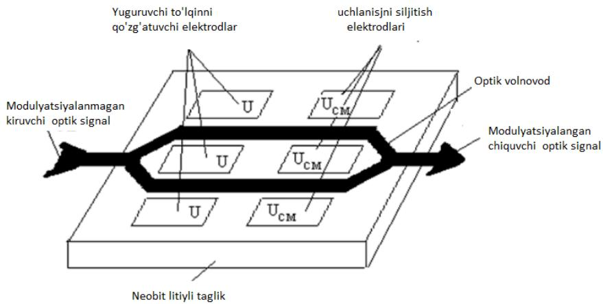
3.11-rasm. Max-Sender interferometri turidagi elektrooptik modulyatorning tuzilish sxemasi.
