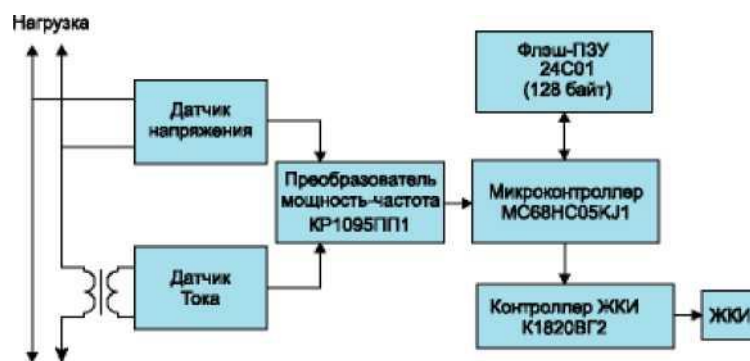
1.4-rasm. Oddiy elektrn hisoblagichning blok-sxemasi.
