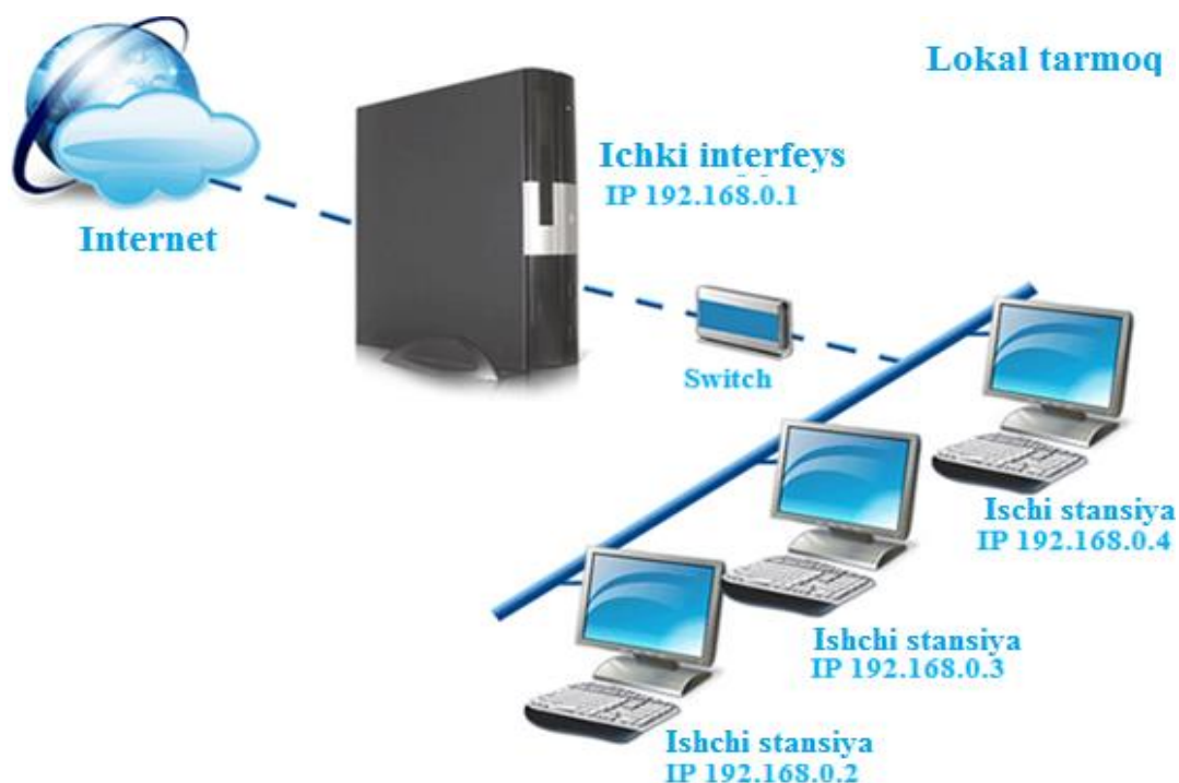
12.5-rasm. Ichki interfeys bilan ta'minlangan ofis tarmog'ining Internetga chiqish namunasi.
