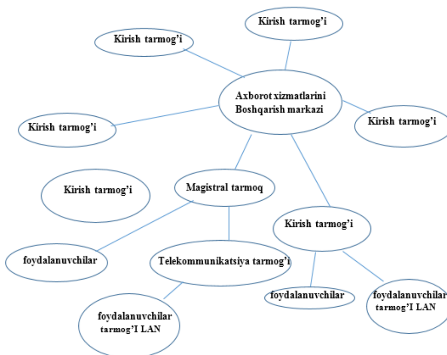
3.6-rasm. Telekommunikatsiya tarmog'ining tarkibiy tuzilishi.
