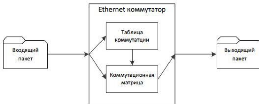
12 – расм. Ethernet коммутаторида сўровни қайта ишлаш жараёнини кўрсатувчи схема.
