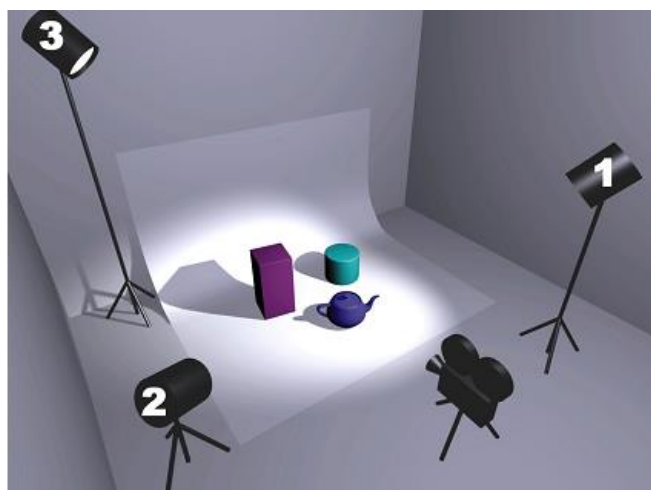
5.87-rasm. Yorug‘likning bazaviy joylashuvi: 1. Asosiy yorug‘lik (Key); 2. To‘ldiruvchi yorug‘lik (Fill); 3. Bo‘luvchi yorug‘lik (Kicker).
