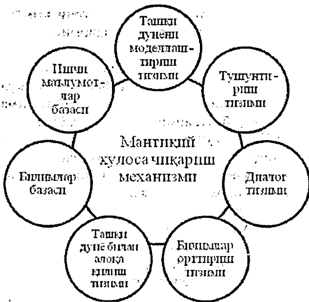
1.1-расм. Динамик типдаги эксперт тизимининг структураси.
