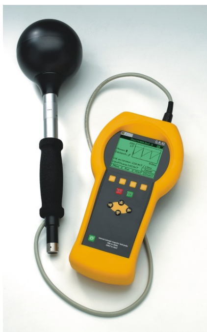
2.3-rasm. Elektr va magnit maydon kuchlanganligini o'lchovchi kichik chastotali asbob (C.A 42).
