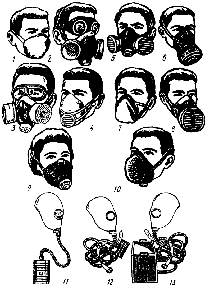
10-расм. Нафас олиш органларини химояловчи респиратор ва газниқоблар. 1 — «Лепесток-200»; 2 — РПГ-67; 3 — РУ-60М; 4 — «Снежок-ГП»; 5 — «Астра-2М»; 6 — ПРШ-741; 7 — «Кама»; 8 — Ф-62ШМ; 9 — У-2К; 10 — РП-Км; 11 — фильтрловчи саноат газниқоб; 12 — шлангали ПШ-1 газниқоб ; 13 — шлангали ПШ-3 газниқоб .
