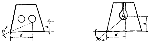
27-rasm. Yoritgichlarning koʻzni himoyalash burchaklari.
