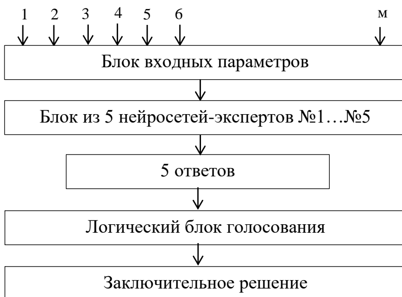
Рис. 1. Схема движения информации для экспертной системы с 5 нейросетями – экспертами
