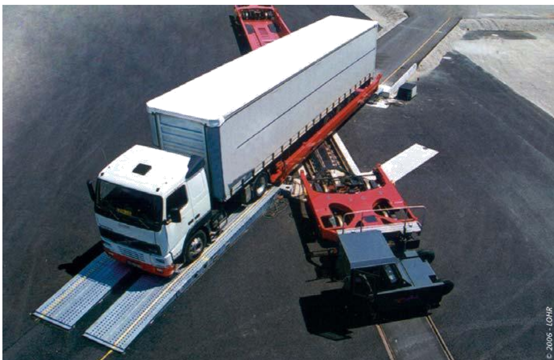
5.9-rasm. Yarim tirkamani “RO-RO” texnologiyasi bo‘yicha maxsus buriladigan temir yo‘l platformalariga yuklash.
