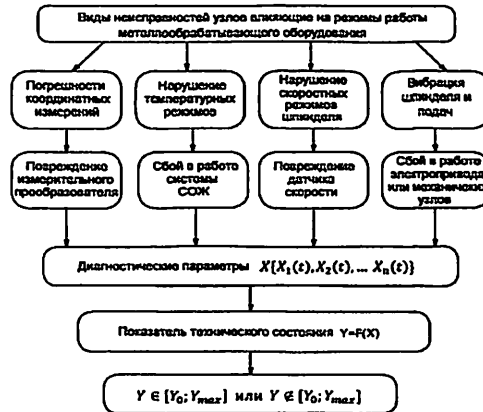
Рис.2. Функциональная схема взаимосвязи неисправностей узлов влияющих на режимы работы металлообрабатывающего оборудования.
