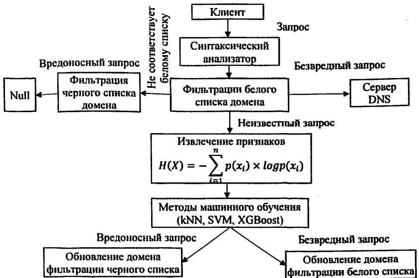
Рисунок 5. Модель предотвращения вредоносного трафика на DNS-серверах: запрос клиент-сервер
