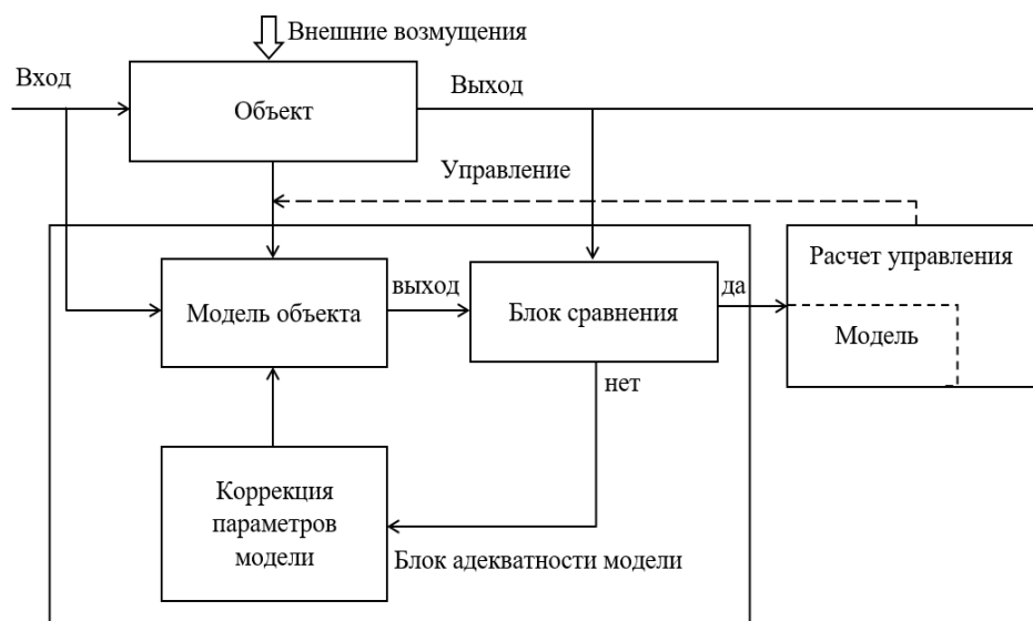
Рис. 2. Функциональная схема механизма адаптации управления тепловой нагрузки
