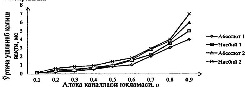
2-расм. Алоқа каналлари юкламасининг маълумотларнинг ўртача ушланиб қолиш вақтига боғлиқлиги.
