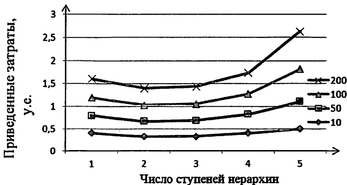
Рис.4. График зависимости общесетевых кумулятивных затрат от числа уровней сети.
