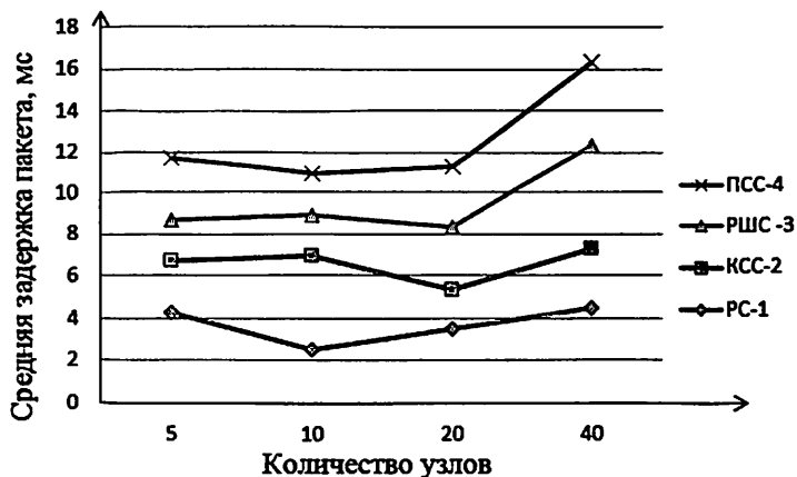
Рис.5. График зависимости средней задержки информации от количества узлов сети.
