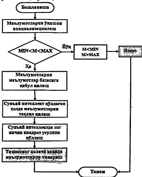
3-расм. Ўрнатилган назорат қилиш марказлаштирилган тизими хатоликлар хотирасидан маълумотларни ўқиш режимида тизимнинг ишлаш алгоритми
