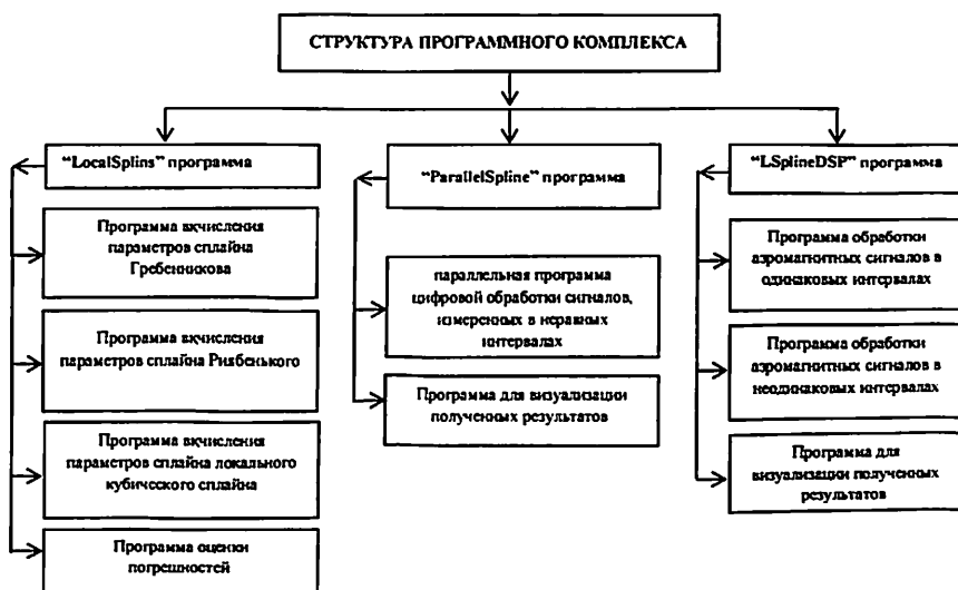
Рис. 4. Структура программного комплекса обработки сигналов локальными сплайнами
