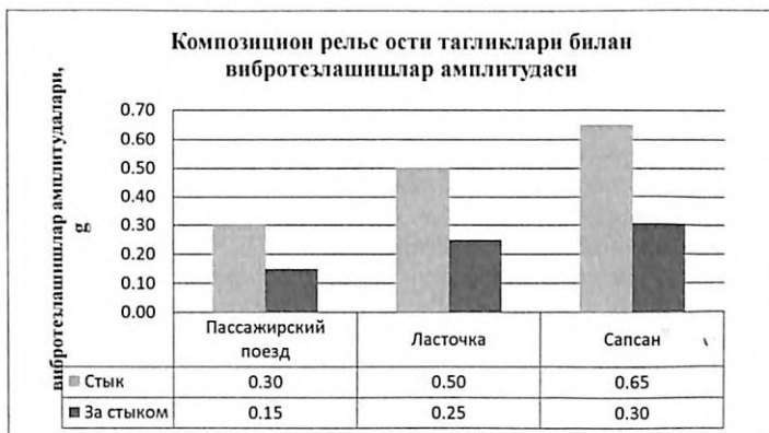
3-расм. Ер полотноси асосий майдонидаги вибротезлашишлар амплитудаси
