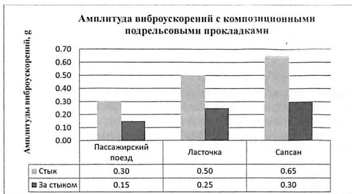
Рис.3. Амплитуда виброускорений на основной площадке земляного полотна
