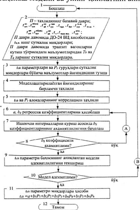
6-расм. Саралаш станцияси ишида t_{сн} параметрини баҳолаш алгоритми блок схемаси: А – йўқотишлар сабаблари гуруҳи P_2 йиғиндисида моделлаштиришдан ўчириб ташлаш жараёни, ушбу коэффициент унча сезиларли эмас; В – моделни қайта шакллантириш жараёни шакллантирилган вақт ва иш ҳақи тўғрисидаги маълумотлар асосида тузилди.
