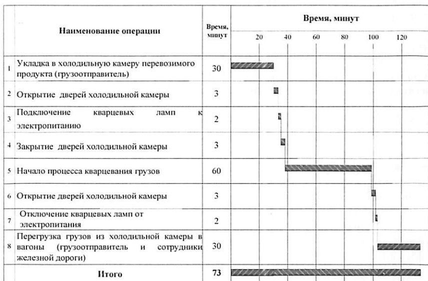
Рис. 7. Технология процесса кварцевания грузов в холодильной камере
