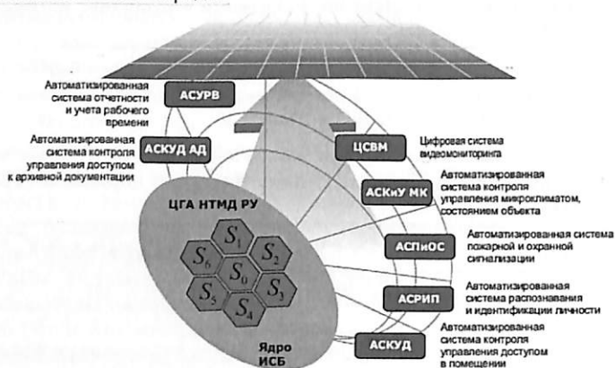
9-расм. Интеграциялашган ахборот-ўлчов тизимининг функционал схемаси.
