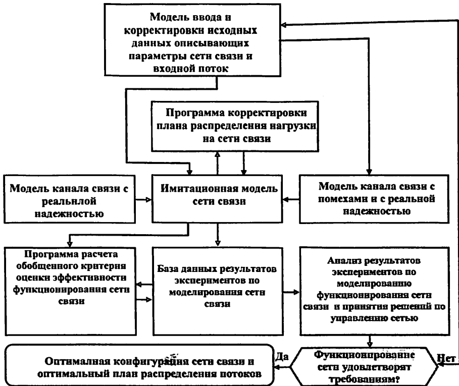
Рис.4.Блок-схема процедуры, реализующей описанную методику управления функционированием сети связи
