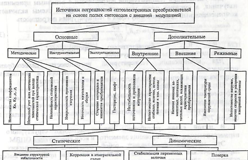
Рис. 5. Классификация источников погрешностей ОПВМ
