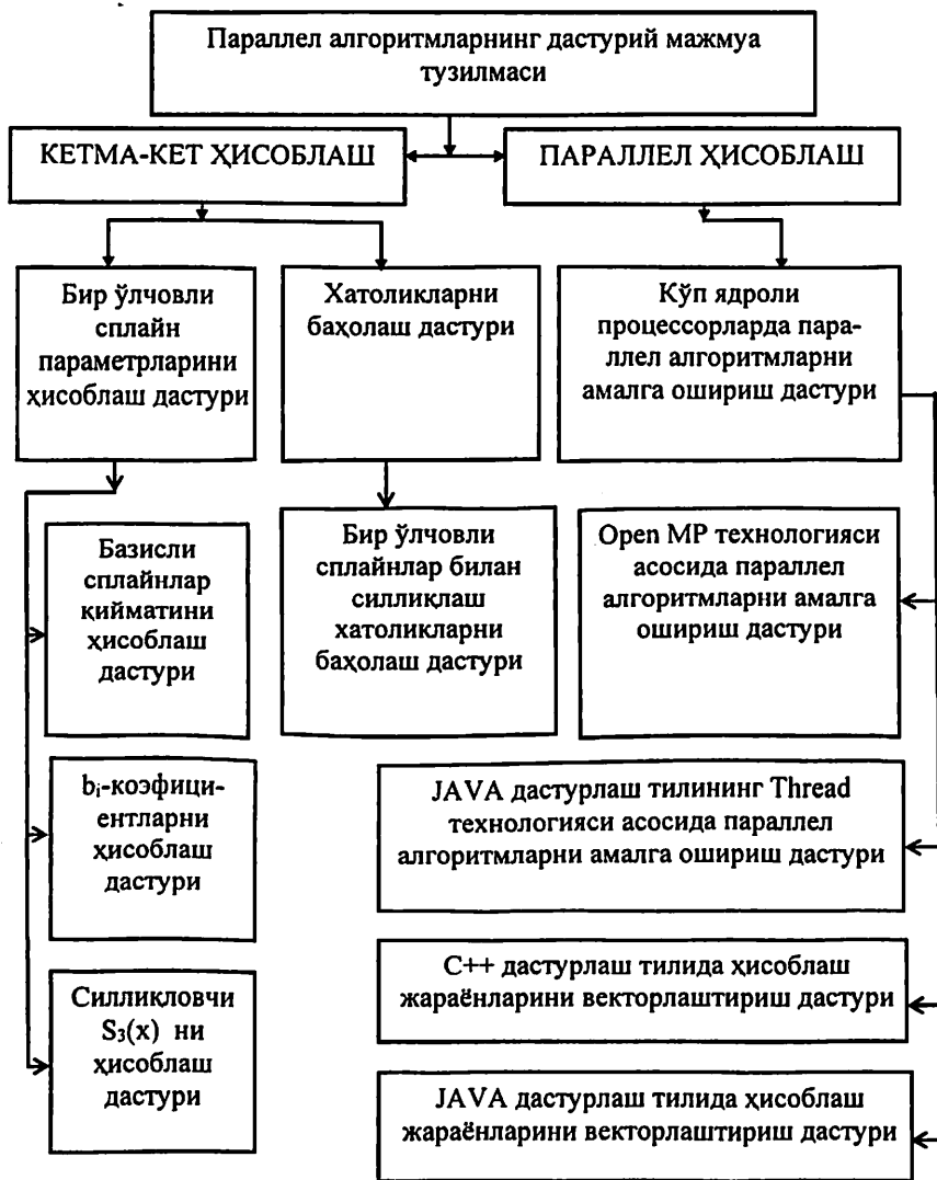
4- расм. Кўп ядроли процессорларга мўлжалланган параллел алгоритмларнинг дастурий мажмуа тузилмаси
