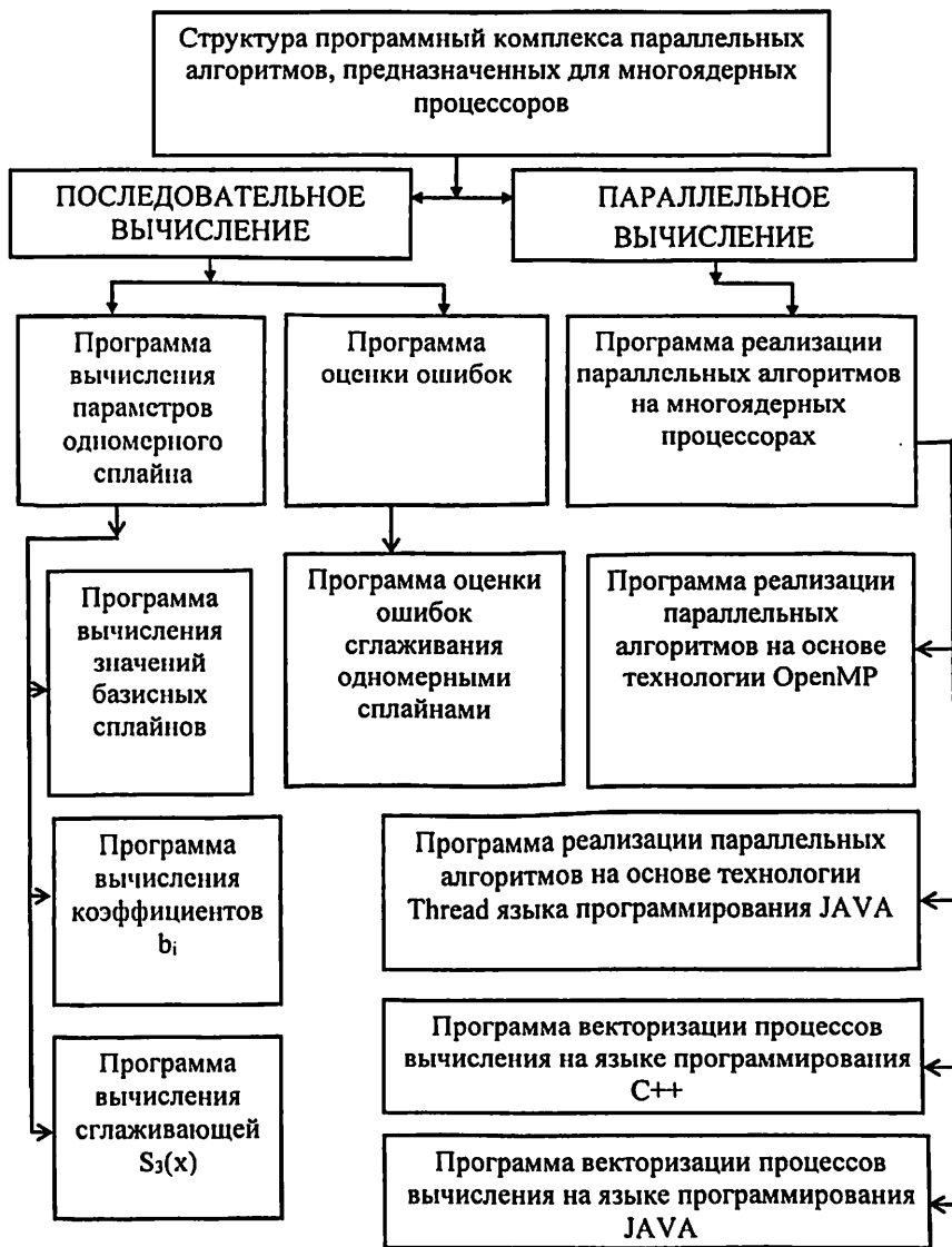
Рис. 4. Структура программного комплекса параллельных алгоритмов, предназначенных для многоядерных процессоров
