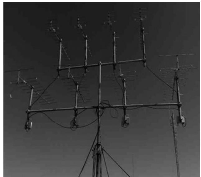
Fig. 2 VHF/UHF Yagi-Uda antenna array
