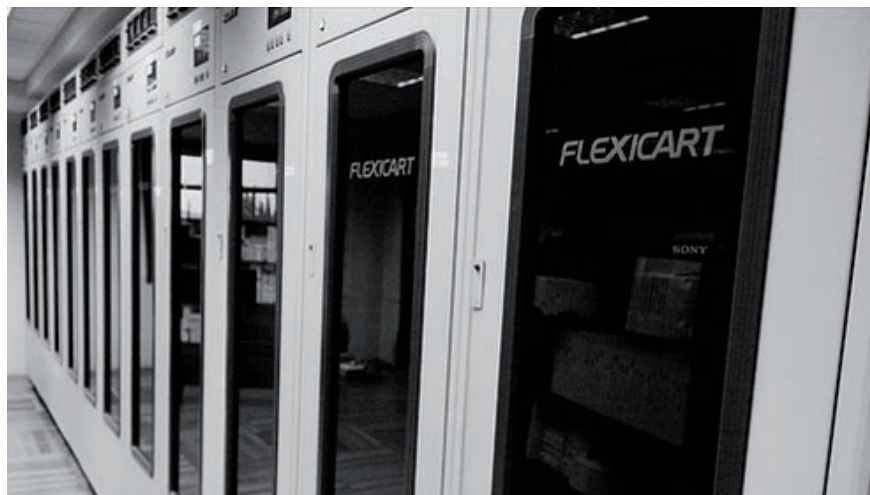
Banco de Flexicarts de Sony, que pueden emitir al aire cintas Betacam SX. Se usa un Flexicart por cada canal.
