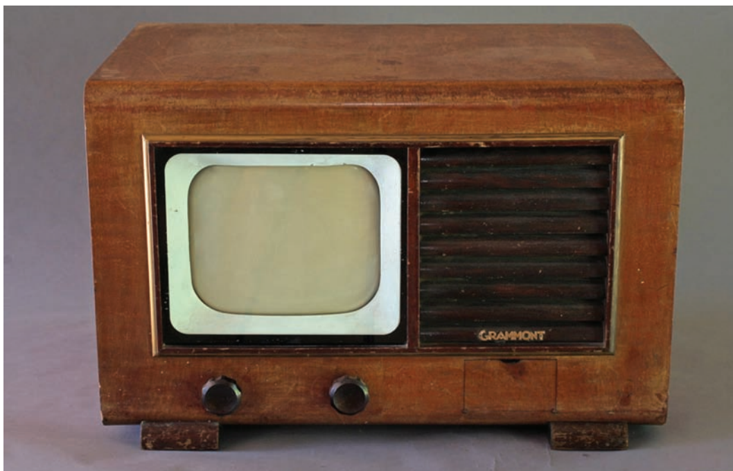
Figure 3: Téléviseur de 441 lignes fabriqué par Grammont en 1949 (© Collection Nicolas Blazianu).
