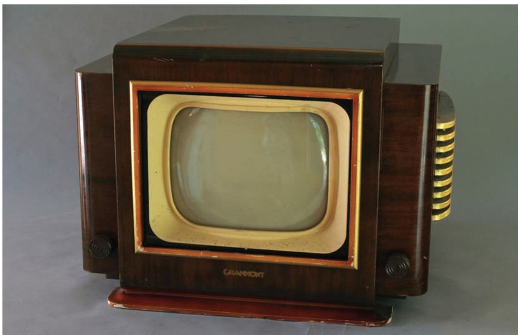
Figure 4: Téléviseur de 819 lignes fabriqué par Grammont en 1951 (© Collection Nicolas Blazianu).
